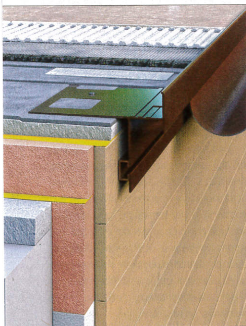
Fot. 3 | Taras – wariant drenażowy – warstwa użytkowa z płytek układanych na kleju na systemowej macie drenażowej. Bezwzględnym wymogiem jest stosowanie profili okapowych dostosowanych do systemu hydroizolacyjnego i warstw drenażowej i użytkowej (fot. Renoplast)
